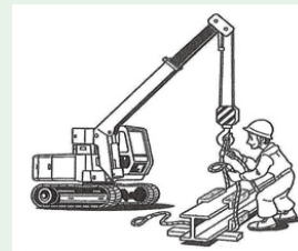
「玉掛けの業務」とは、つり具(ワイヤーロープ、チェーン等)を用いて行う、荷かけ及び荷はずしの業務です。 全登協「玉掛け教本」より
